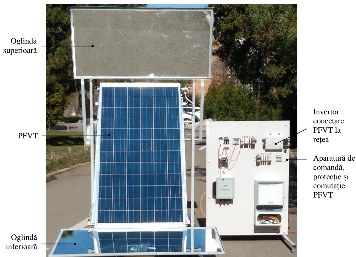
Fig. 2. Stand experimental utilizat pentru determinarea performanțelor PFVT.
