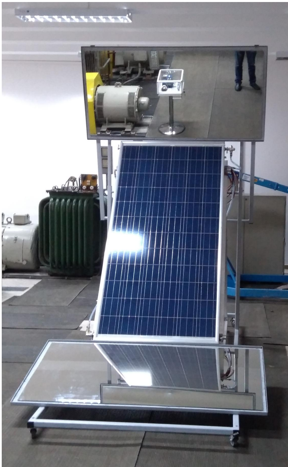
Fig. 7. Modelul experimental al PFVT echipat cu concentratoare solare (oglinzi plane).
